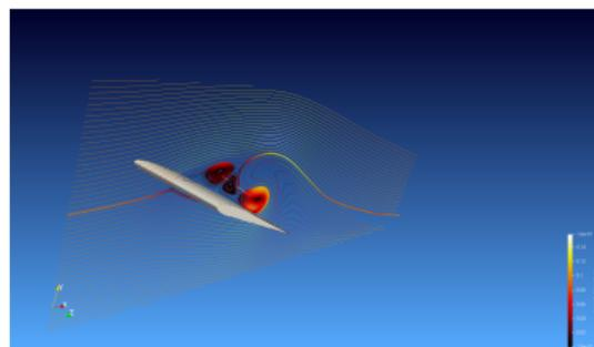
Calculs laminaires 3D via LBM-VP implémentés dans le code LBM opensource *Palabos*
